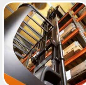
2. Компактные размеры и двигатель подъема мощностью 5,5кВ обеспечивают высокую эффективность работы в ограниченных пространствах. Благодаря боковым гидравлическим стабилизаторам значительная остаточная грузоподъемность сохраняется до высот подъема до 6500мм.
