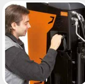
3. Конструкция батарейного отсека обеспечивает свободный доступ для обслуживания. Батарея устанавливается на ролики и фиксируется системой быстрого крепления.
