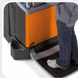
3. Просторная платформа оператора на подвеске – комфортная работа в течение дня. Для высоты подъема свыше 3300мм ширина шасси увеличена до 926мм; поддерживающие колеса защищены металлическими накладками.
