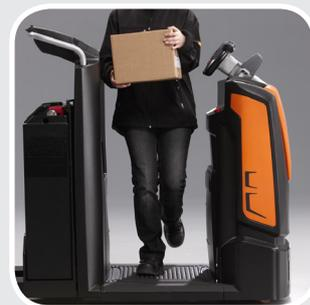
2. Благодаря просторной кабине и индикации присутствия в любой точке платформы, оператор может занять наиболее комфортное положение, а также легко пройти через подборщик, что увеличивает эргономичность и скорость работы.
