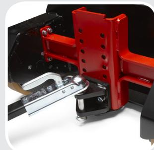
3. Регулируемое шарнирное или штыревое сцепное устройство позволяет осуществлять транспортировку различных типов контейнеров.
