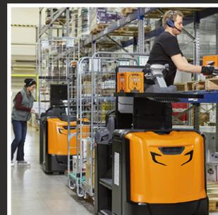
1. Поднимающаяся платформа оператора и полка для промежуточного хранения мелких грузов упрощают подбор со второго уровня.
