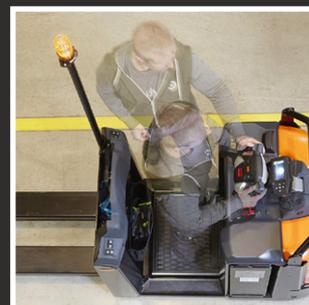
3. Пол отделения оператора оснащен комфортной подвеской и выполняет функцию индикации присутствия оператора в любой точке платформы: можно мгновенно начать движение и занять удобное положение при работе.
