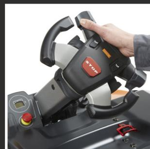
2. Инновационное регулируемое рулевое колесо с углом поворота 100° позволяет выполнять маневры точно и с минимальным усилием, даже в ограниченном пространстве. Оператор может использовать различные приемы управления, в том числе одной рукой.
