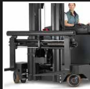
3. Каждое грузовое колесо оснащено собственным электродвигателем рулевого управления, контроллером и тормозной системой и способно совершать поворот на 360° в любом направлении, для маневренности, скорости и точности обработки. Конструкция шасси предотвращает риск повреждения грузовых колес и обеспечивает легкий доступ в случае необходимого сервисного обслуживания.
