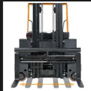
1. Позиционер вил со встроенной функцией наклона и широким раскрытием позволяет обрабатывать грузы разных размеров, делает работу точной и легкой.
